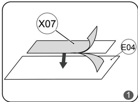
для более сильной фиксации рекомендуем использовать дополнительно клей-герметик типа жидкие гвозди. (Scotch-Seal 5300; Scotch-Wld 5300)
