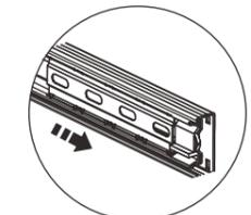
Для улучшения работы направляющей при установке доводчика извлечь резиновый ограничитель хода с направляющей.
