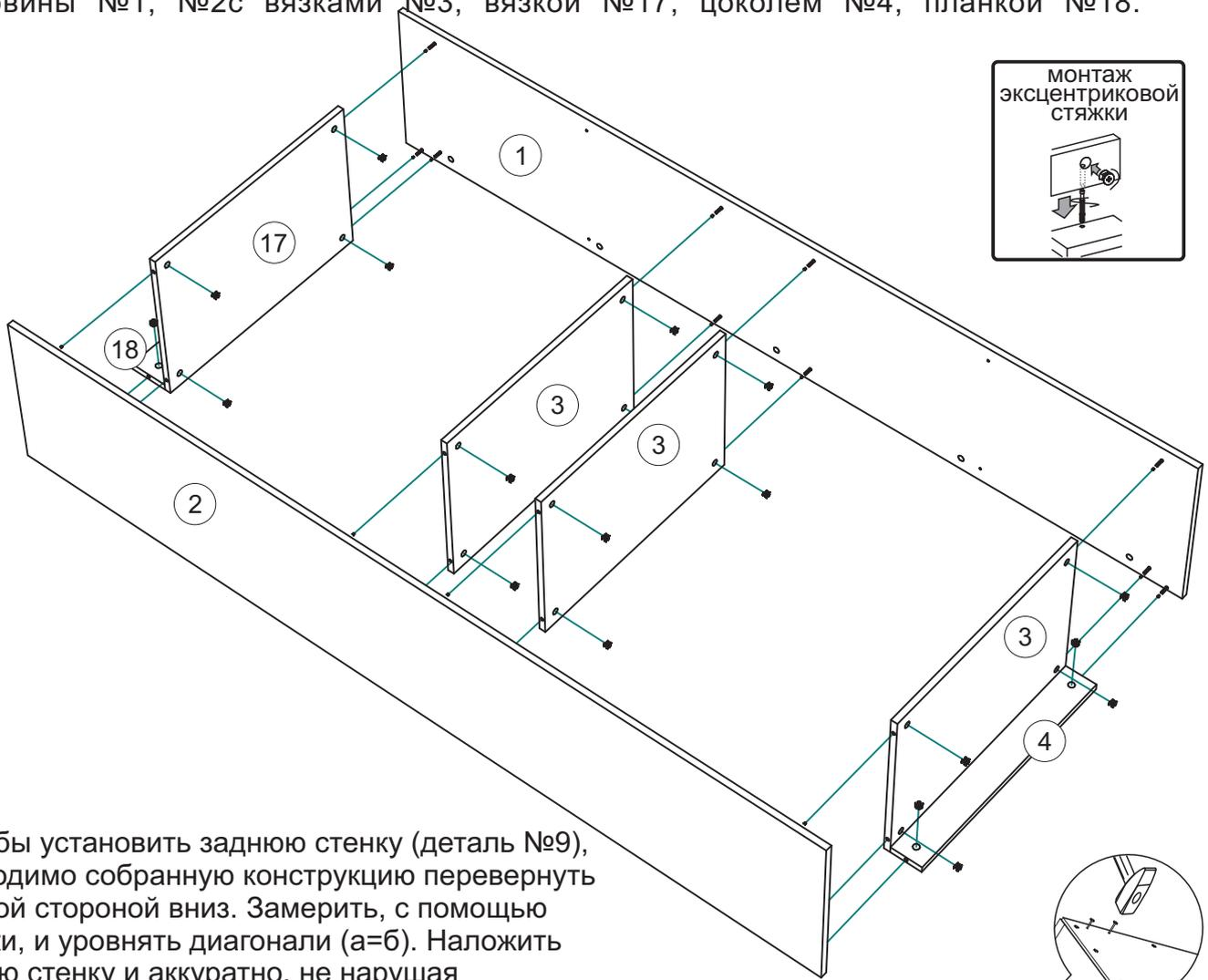
**5. Чтобы установить заднюю стенку (деталь №9), необходимо собранную конструкцию перевернуть лицевой стороной вниз. Замерить, с помощью рулетки, и уровнять диагонали ( $a=b$ ). Наложить заднюю стенку и аккуратно, не нарушая диагоналей, прибить ЛДВП гвоздями, с шагом 130-150 мм, затем также гвоздями прибить подпятники на боковины.**
