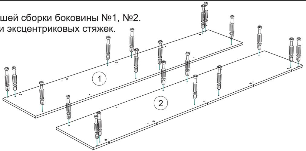
**4. Соберите каркас пенала. Для этого с помощью эксцентриковых стяжек соедините боковины №1, №2 с вязками №3, вязкой №17, цоколем №4, планкой №18.**
