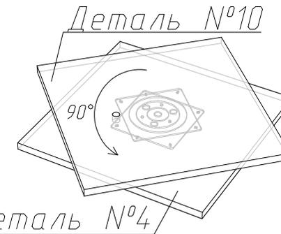
1. Деталь № 10 с установленным механизмом расположить на детали 4 и отверстие  $\varnothing 15$  совместить с наметочным отверстием на детали №4.
