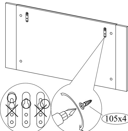
Померять расстояние между отверстиями (A), разметить отверстия в стене и просверлить.
